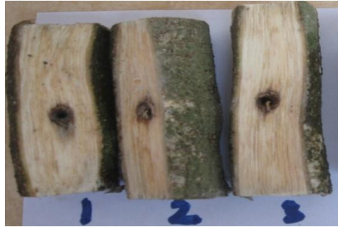
Gambar 1. Persebaran zona perubahan warna pada beberapa perlakuan 1: kedalaman sekrup 1 cm, 2: kedalaman sekrup 1,27 cm dan 3: kedalaman sekrup 1,54 cm
