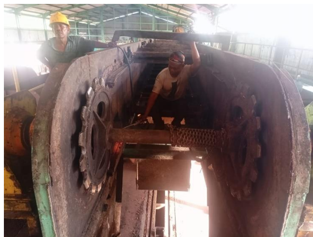
Gambar 2. Mekanik Perbaikan Chain Anjlok
