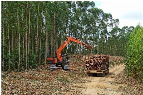
Gambar 2. Memuat Kayu Dengan Bantuan Excavator Grapple.
